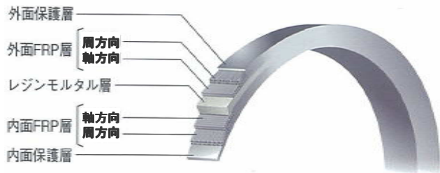
第2図 FRPM管（エスロンRCP）構造図
